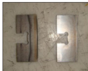
(esquerda) Desgaste excessivo/prematuro nas palhetas. (Direita) Exemplo de áreas corroídas.
